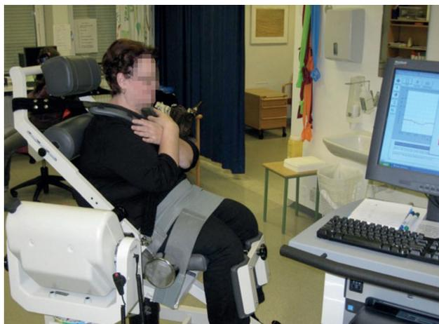
**Figura 1.** Biodesx® System-4 con la unidad de abdomen posterior.
